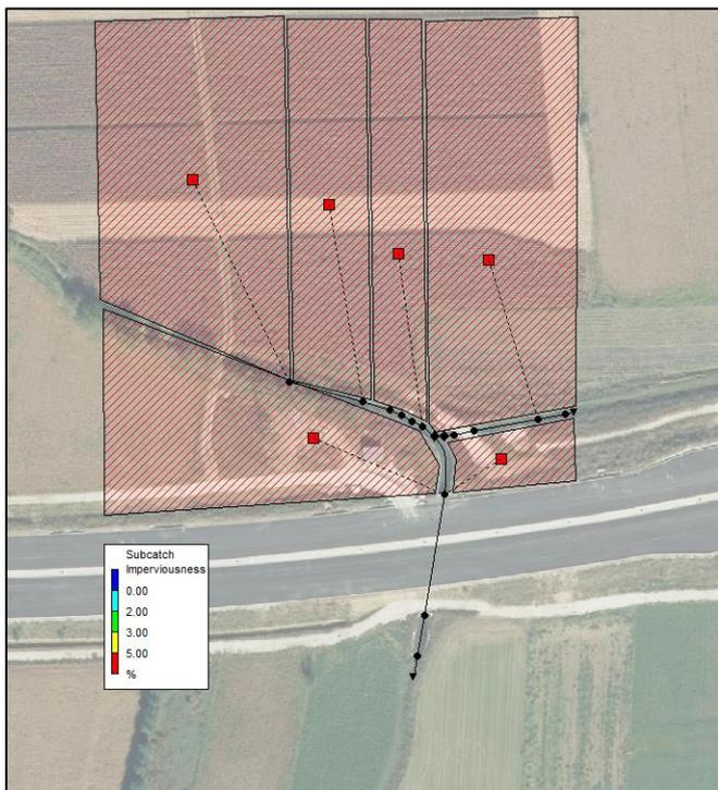
Il modello idraulico del nodo dello sfioratore della Pedemontana, oggetto della modellazione è stato discretizzato in 6 sottobacini data la dimensione ridotta dell'area.
